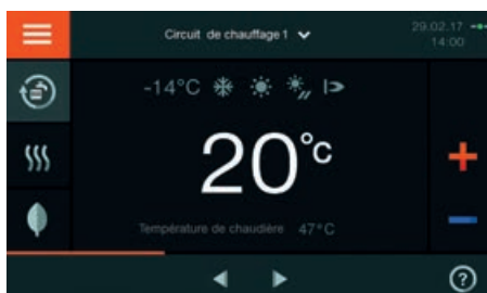
Régulation Vitotronic avec écran tactile couleur
